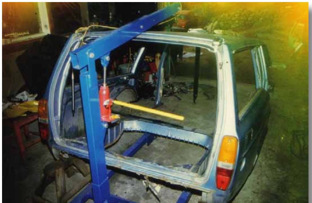
Her henger toppen fra 145'n i krana og venter på at en noe letta 164 skal rygge inn under det nye taket som skal på. Kan love at det ble mange timer med å borre ut sveisepunkter slik at alt som ikke skulle brukes var fjernet. Men gjør en det ordentlig med en gang så får man det igjen for da passer det der det skal.
